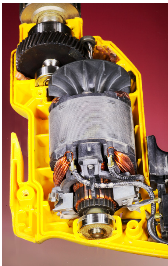
Rysunek 23.12. Silnik wiertarki elektrycznej zawiera wirnik z cewkami zasilanymi za pomocą komutatora i szczotek — takie rozwiązanie pozwala regulować prędkość obrotową; w przypadku większości silników AC regulacja prędkości nie jest możliwa, a wirnik nie jest w żaden sposób połączony elektrycznie z pozostałą częścią silnika
