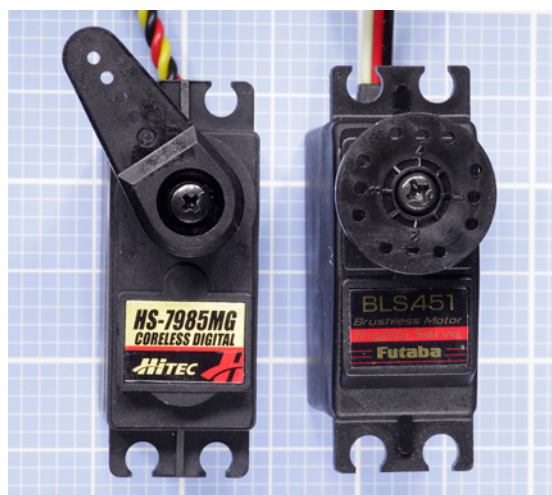
Rysunek 24.1. Typowe serwo RC może generować moment obrotowy na poziomie przekraczającym 0,35 Nm; zazwyczaj jest zasilane trzema lub czterema bateriami alkalicznymi AA połączonymi szeregowo i waży mniej niż 55 gramów
