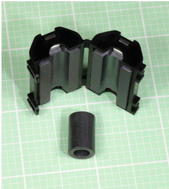
Rysunek 14.13. Dwa przykłady filtrów ferrytowych; służą do blokowania promieniowania radiowego generowanego przez przewód lub do ochrony przewodu przed podobnymi zakłóceniami
