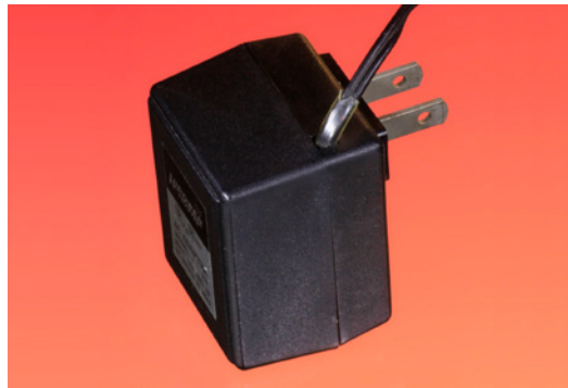
Rysunek 16.2. Prosty zasilacz transformatorowy zamknięty w obudowie z tworzywa sztucznego można podłączyć bezpośrednio do gniazdka elektrycznego; obecnie coraz częściej stosowane są zasilacze impulsowe, które zwykle są lżejsze, mniejsze i tańsze
