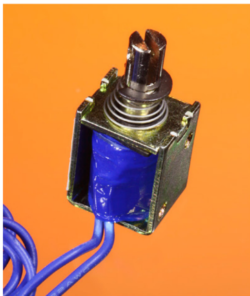
Rysunek 21.1. Niewielki solenoid (elektromagnes z ruchomym rdzeniem) o napięciu znamionowym 12 V DC
