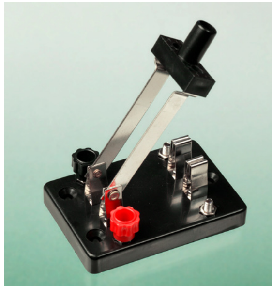
Rysunek 6.2. Przełącznik nożowy typu DPST przeznaczony do celów edukacyjnych
