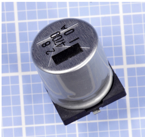
Rysunek 12.8. Większość kondensatorów przeznaczonych do montażu powierzchniowego ma wymiary porównywalne z innymi elementami montowanymi tą metodą, ale ten kondensator elektrolityczny o pojemności 4700 \mu\text{F} i napięciu znamionowym 10 V ma kwadratową podstawę o boku długim na 1,5 cm. Na środku bliższego boku widać końcówkę lutowniczą
