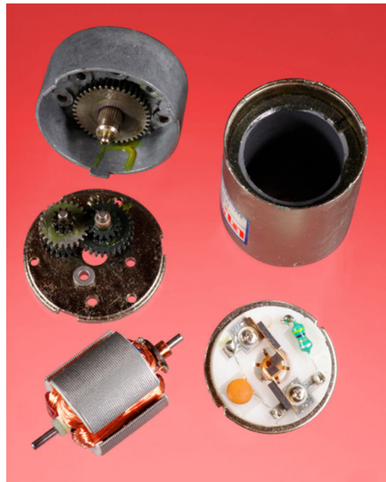
Rysunek 22.7. Przekładnie zębate czołowe działające w motoreduktorze zmniejszają prędkość obrotową na rzecz momentu obrotowego
