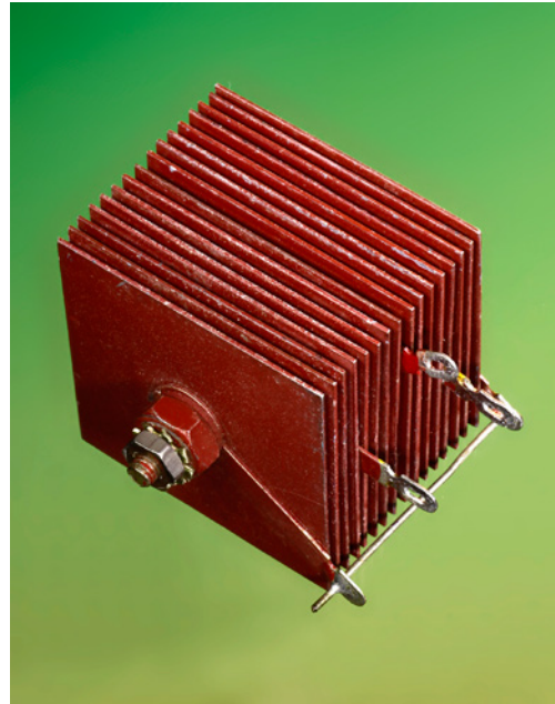
Rysunek 26.11. Zanim pod koniec lat 60. ubiegłego wieku zaczęto produkować układy scalone, często stosowano takie prostowniki krzemowe, które zajmowały powierzchnię około 13 cm 2
