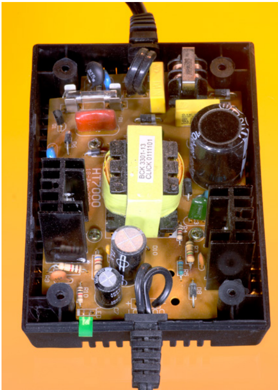
Rysunek 16.5. Wnętrze jednego z pierwszych zasilaczy impulsowych
