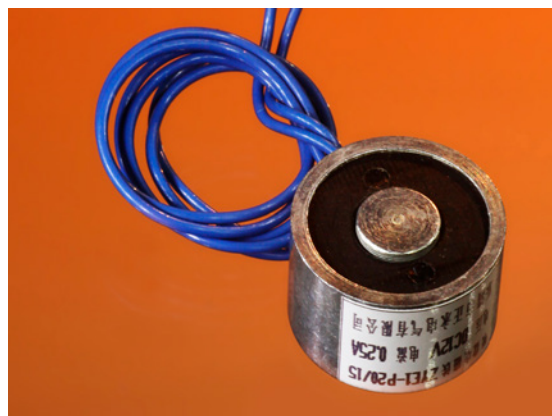
Rysunek 20.1. Elektromagnes o średnicy 2 cm pobierający prąd znamionowy 0,25 A przy napięciu 12 V DC
