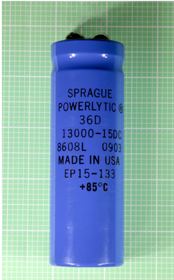
Rysunek 12.11. Ten kondensator elektrolityczny o pojemności 13 000 \mu\text{F} raczej nie znajdzie zastosowania w zwykłych urządzeniach codziennego użytku
