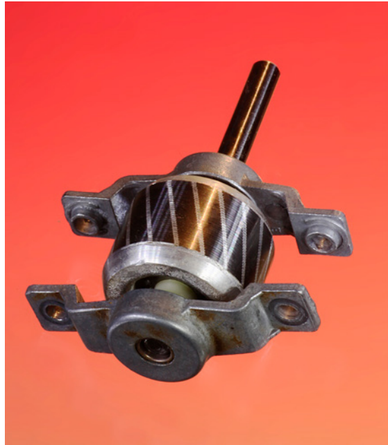
Rysunek 23.8. Wirnik silnika niewielkiego wentylatora; aluminiowa klatka wraz z zakończeniami mają kolor jasnoszary, natomiast stalowe płytki mają ciemniejszy odcień
