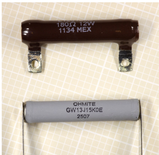
Rysunek 10.11. Dwa rezystory drutowe różniące się znacznie rezystancją, ale mające podobną moc
