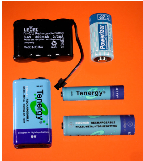
Rysunek 2.9. U góry po lewej: zestaw ogniwi NiCd stosowany w telefonach bezprzewodowych; u góry po prawej: akumulator litowy do aparatu fotograficznego; u dołu: trzy akumulatory NiMH będące zamiennikami popularnych baterii alkalicznych
