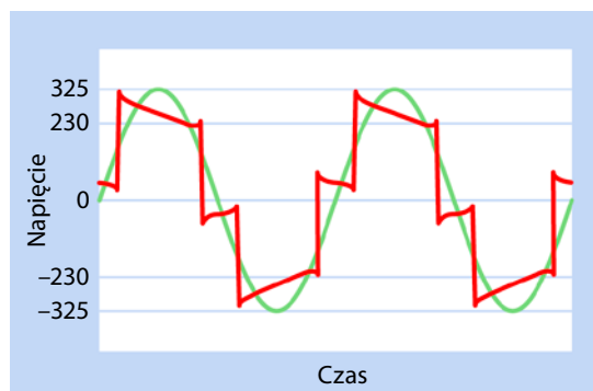
Rysunek 18.6. Tani falownik może generować zniekształcony przebieg, który będzie nawet bardziej zaszumiony niż zwykły przebieg prostokątny; ten przykładowy przebieg przedstawia rzeczywisty oscylogram
