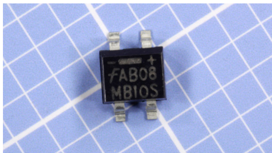
Rysunek 26.14. Ten element do montażu powierzchniowego zawiera cztery diody składające się na obwód dwupołówkowego mostka prostowniczego o ciągłym prądzie znamionowym 0,5 A; zajmuje powierzchnię około 1,3 cm 2
