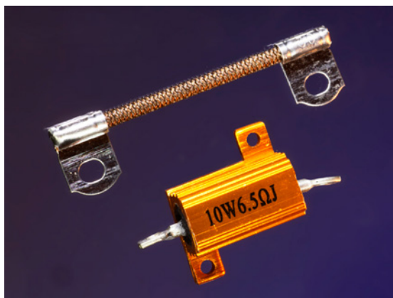
Rysunek 10.14. U góry: rezystor 30\text{-omowy} ; u dołu: rezystor 6,5\text{-omowy}
