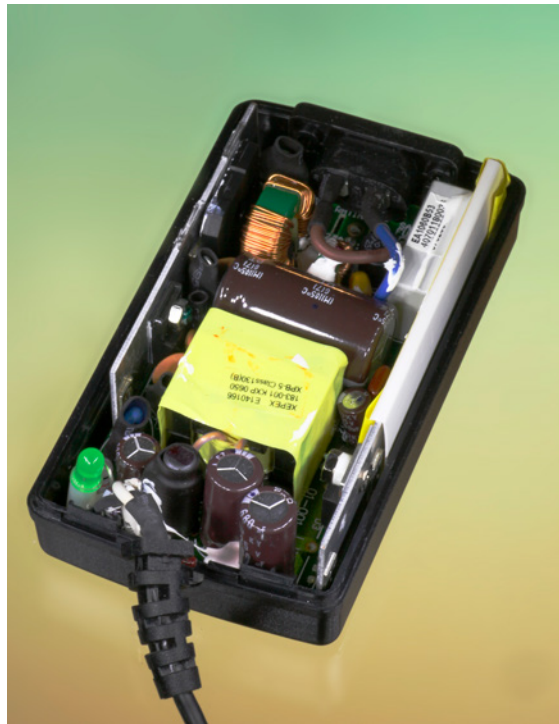
Rysunek 16.6. Wnętrze zasilacza impulsowego służącego do zasilania laptopa
