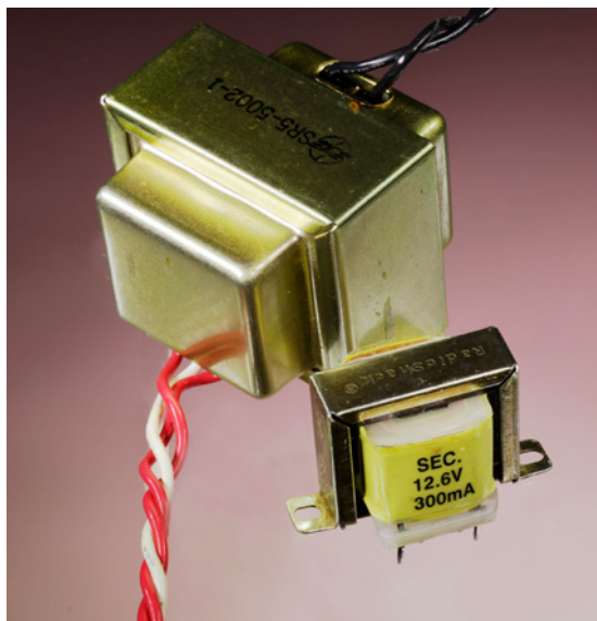
Rysunek 15.1. Dwa niewielkie transformatory mocy; ten z tyłu ma wymiary 2,5 cm × 5 cm × 5 cm i odznacza się napięciem znamionowym 36 V AC przy natężeniu 0,8 A; napis „SEC” na mniejszym transformatorze jest skrótem od angielskiego słowa „secondary” oznaczającego „wtórne” i odnosi się do wartości znamionowych uzwojenia wtórnego
