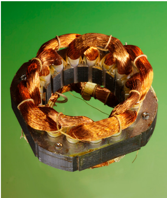
Rysunek 23.2. Stojan dużego wentylatora elektrycznego; każda cewka z drutu miedzianego jest wycentrowana na wypuszczeniu rdzenia skierowanym do środkowego otworu, w którym montuje się wirnik; cewki nachodzą na siebie, ponieważ ich średnice są zwiększone w celu zmaksymalizowania siły magnetycznej; każda z nich ma odczepy umożliwiające skokową zmianę prędkości za pomocą zewnętrznego przełącznika obrotowego
