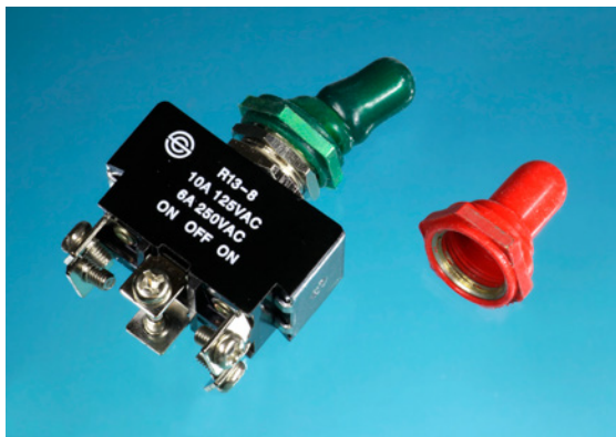
Rysunek 6.14. Gumowa lub winylowa osłonka chroni wnętrze przełącznika przed brudem i wilgocią; osłonka ma gwint i może być nakręcona na przepust dźwigni, co pokazano w lewej części rysunku
