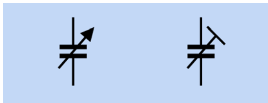
Rysunek 13.1. Typowe symbole elektryczne kondensatora zmiennego (po lewej) i nastawnego (po prawej)
