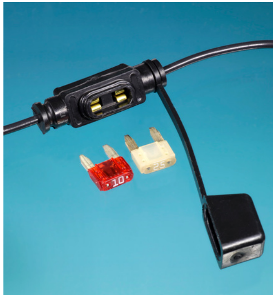
Rysunek 4.6. Dwa typowe bezpieczniki samochodowe i oprawka przelotowa umożliwiająca bezpieczne zasilanie dodatkowych akcesoriów elektrycznych; po zamontowaniu bezpiecznika oprawka jest zamykana widoczną z prawej strony osłonką
