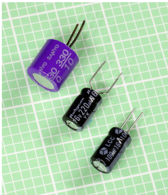
Rysunek 12.5. Kondensatory walcowe z radialnymi wyprowadzeniami; wszystkie są elektrolityczne
