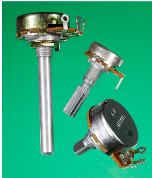
Rysunek 11.6. Trzy potencjometry różniące się konstrukcją ośki
